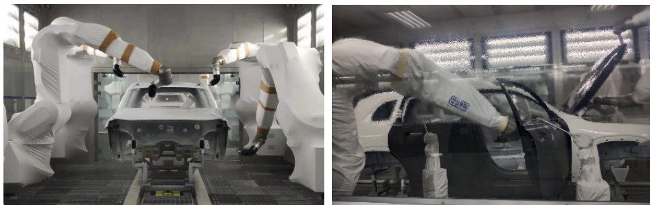
图8 全机器人自动喷涂线示意图
